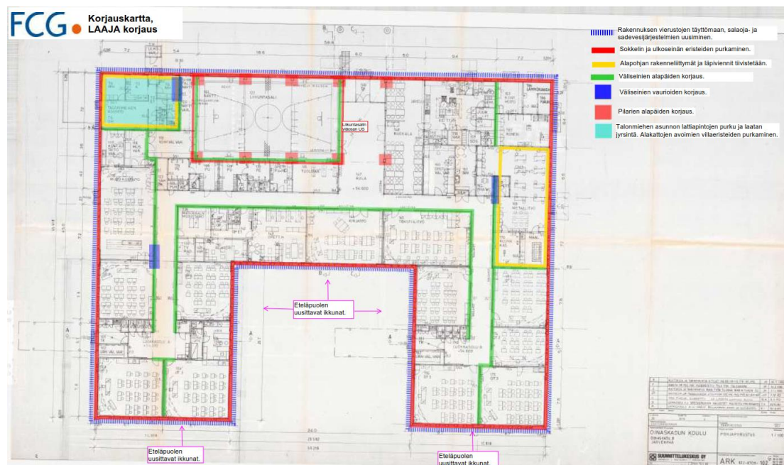
Kuva 1. Rakennuksen pohjapiirustus, johon on koostettu laajasta korjauksesta korjauskartta. Lähde: Korjaustapaehdotus ja kustannuslaskenta päivitetty 21.4.2020 ja 19.11.2020, FCG
